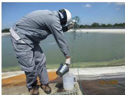
ภาพที่ 3.4.5-4 แสดงการเก็บตัวอย่างคุณภาพน้ำบริเวณบ่อรวบรวมน้ำ (Sump) ของอ่างเก็บน้ำทิ้ง ระหว่างเดือนกรกฎาคม-ธันวาคม พ.ศ. 2565
